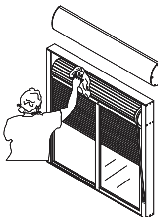
Figura 1 – Tampa retirada para limpeza.
