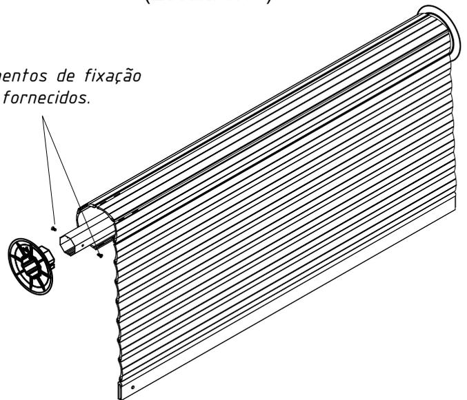
*NOTA: Não recomenda-se aplicação de disco alinhador DIA40118 para persianas com motorização, visto que o parafuso de fixação do disco alinhador poderá danificar o motor se o parafuso atingir o eixo do motor.*
