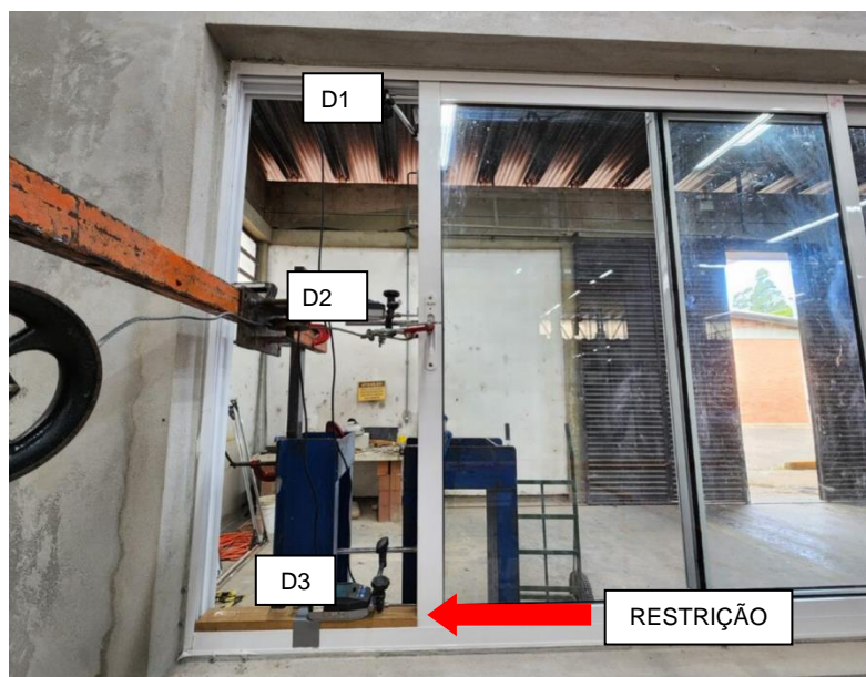
Figura 2 – Instrumentação de ensaio de resistência horizontal com um canto imobilizado
