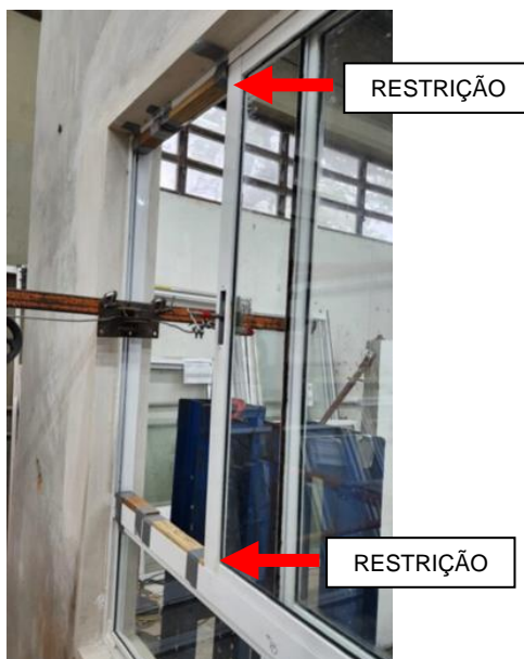
Figura 3 – Instrumentação de ensaio de resistência horizontal com dois cantos imobilizados
