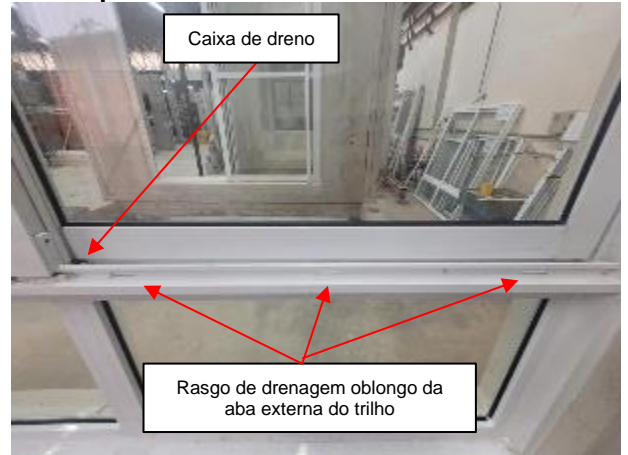
Figura C.2 – Vista externa da esquadria – rasgos de drenagem
