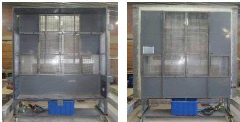
Figura 2 – Vistas da câmara de ensaio: (a) vista interna, e (b) vista externa
