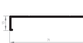
EXL-007 Marco de correr lateral liso 0,386 Kg/m
