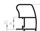
EXL-504 Montante bitubular central interno 0,790 Kg/m
