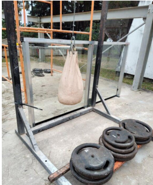
Figura 6 – Condições do guarda-corpo após o ensaio de impacto
