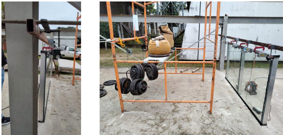
Figura 5 – Condições da amostra durante a realização do ensaio de esforço horizontal
