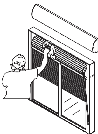
Figura 1 – Tampa retirada para limpeza.
